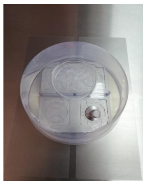
Kuva 11.8 Kaasukupu asetettuna kaasusuutin
